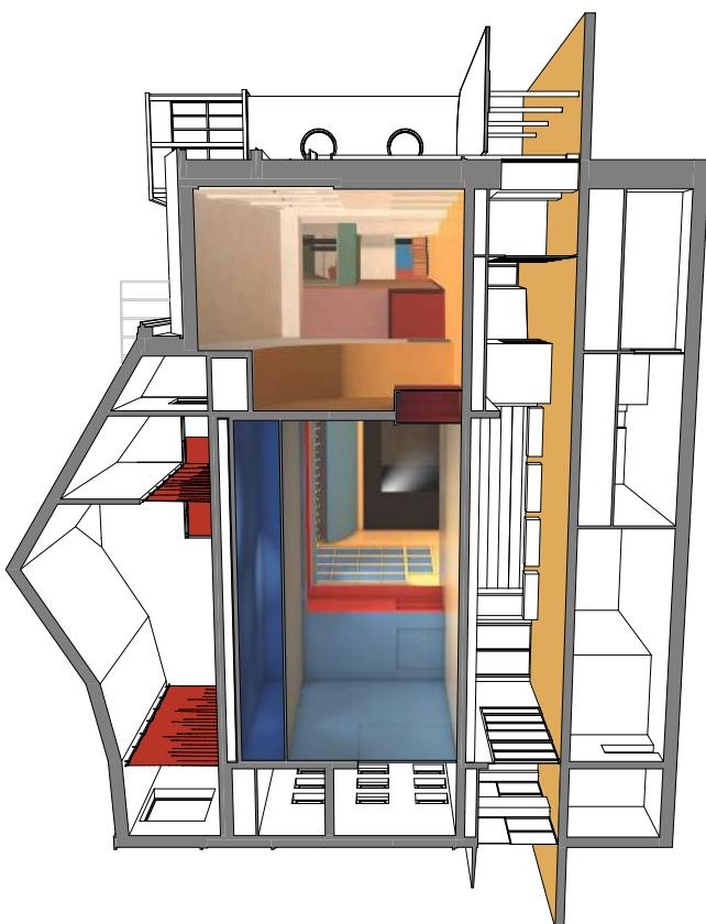
Schnitt durch den Mittleren Saal und Foyer im Altbau mit Blick durch den Grossen Saal zur Bühne
